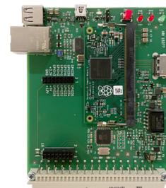
Ein modernes Architekturkonzept auf Basis von sicheren und offenen Technologien erlaubt die effektive Vernetzung der MC 1500 Zentrale mit anderen IT-basierten Systemen in IoT-Umgebungen. Die "Edge-Device-Server"-Baugruppe erfasst, verarbeitet und speichert die Daten lokal und reduziert dadurch das Datenaufkommen. Ebenso ist ein autonomer Betrieb möglich.
